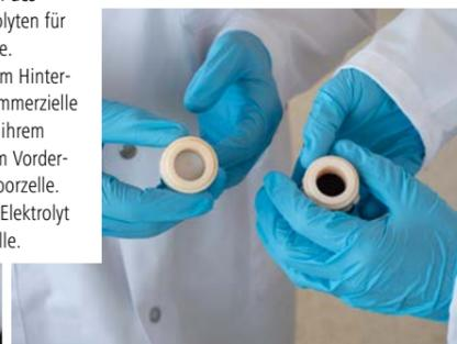
gemeinsamen flüssigen Elektrolyten «schwimmen», ist der Elektrolyt bei einer Salzbatte-rie ein Feststoff, namentlich ein keramischer Ionenleiter auf Natrium-aluminiumoxid-Basis. Der Festelektrolyt ist nicht brennbar und ermöglicht zudem eine Abtrennung von Anode und Kathode, was die Lebensdauer der Batterie erhöht. Die Kathode einer Salzbatte-rie basiert auf einem Granulat aus Kochsalz und Nickelpulver, die Natriummetail-anode entsteht erst beim Aufladen.
