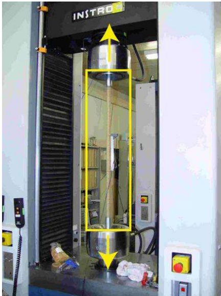
Tensile test on a FRP-rebar @ Empa
