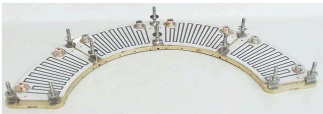
**Abb. 11:** Beheizbare Metall-Keramik – Struktur / Prototyp (gelötet mit Au-12Ge): Thermozyklische Tests und Vibrationstest bestanden.
