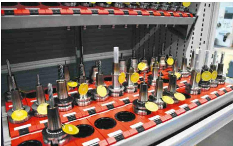
Etlliche Fräser, Bohrer und Gewindeschneider befinden sich in den Werkzeugkästen der Maschinen.
