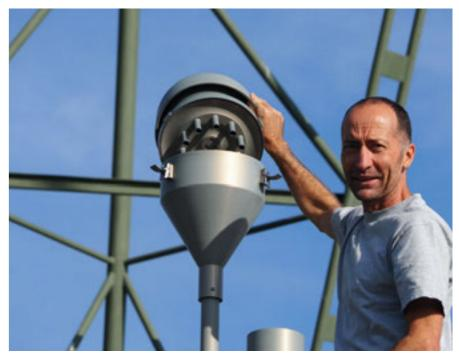
Die Feinstaubpartikel werden am Fuss des Turms, auf dem Dach des früheren Betriebsgebäudes mit so genannten Impaktoren eingesammelt. Christoph Hüglin (Bild links) und Stefan Bugmann analysieren nicht nur die online übertragenen Messwerte, sondern auch den Inhalt der Filter.
