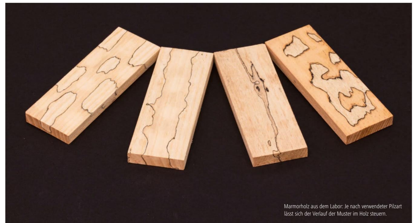
Marmorholz aus dem Labor: Je nach verwendeter Pilzart lässt sich der Verlauf der Muster im Holz steuern.
