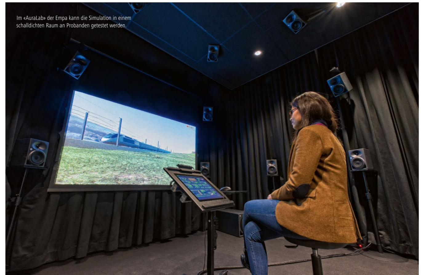
Im «AuraLab» der Empa kann die Simulation in einem schalldichten Raum an Probanden getestet werden.
