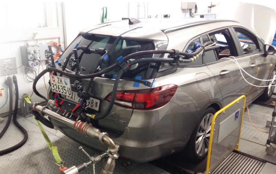
Ein Opel Astra 1.6 CDTI auf dem Rollenprüfstand der Empa. Die Schläuche verbinden den Auspufftrakt mit einem mobilen PEMS-Messgerät im Inneren des Autos. In der gleichen Konfiguration geht es dann auf die Strecke rund um den Greifensee.
