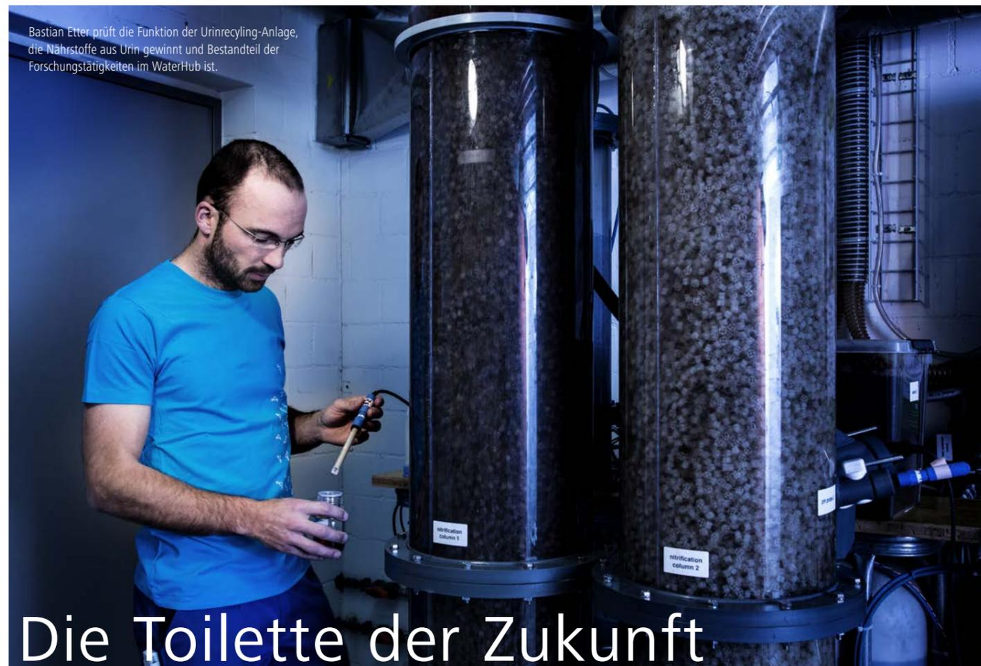
Bastian Etter prüft die Funktion der Urinrecycling-Anlage, die Nährstoffe aus Urin gewinnt und Bestandteil der Forschungstätigkeiten im WaterHub ist.
