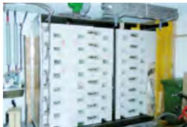
Die Module des Betonspeichers werden an der Empa in Spezialformen gegossen und härten aus. Der Speicher selbst besteht aus 24 solchen Modulen, die per Gabelstapler angeliefert werden. Jeder Quader wiegt rund 400 kg und ist von Kupferleitungen durchzogen. Die Quader werden in ein isoliertes, wasserdichtes Metallgehäuse gestellt. Den Anschluss an die Hausheizung erledigt der örtliche Installateur.
