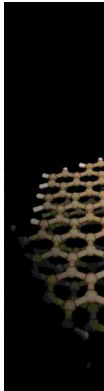
Strukturmodell eines Graphenbandes in Form einer Zickzacklinie.
