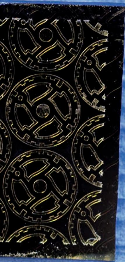
Weltneuheit aus den Empa-Labors: hochpräzise Edelstahl-Bauteile aus galvanischer Fertigung. Die rostfreie Legierung entsteht also nicht im Hochofen, sondern – kostengünstig – in einem Becken mit kaltem Wasser.
