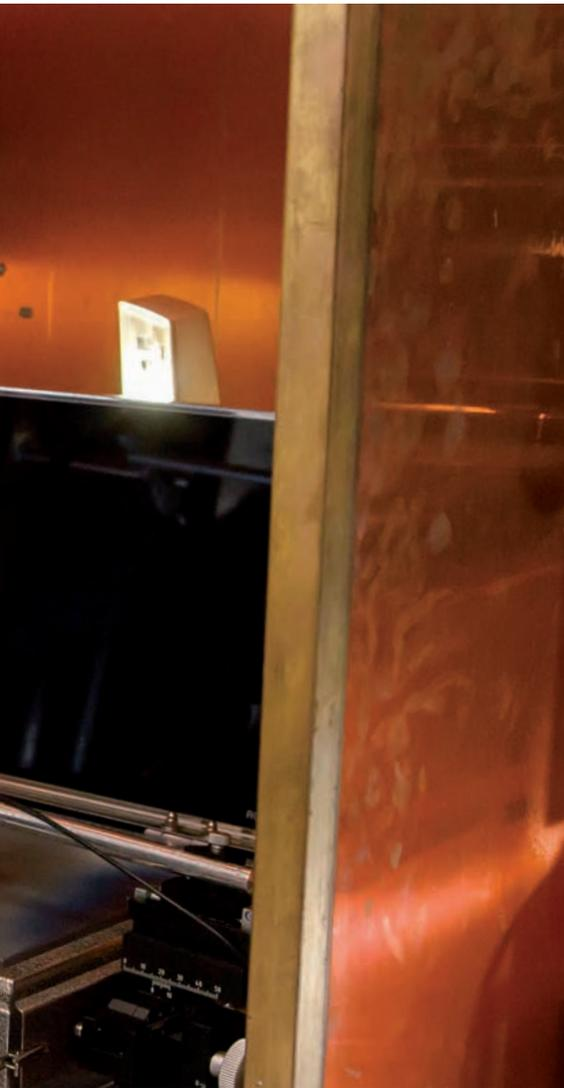
Lars Jeurgens und sein Kollege Thomas Suter prüfen einen neuen Versuchsaufbau: Ein Probenstück mit 200 übereinander liegenden Nano-Schichten wird auf 700 Grad erhitzt. Sobald geschmolzenes Kupfer durch die Barrierschichten dringt, fließt ein extrem schwacher Strom. Um elektrische Störungen auszuschliessen, ist der ganze Versuchsaufbau mit Kupferblechen abgeschirmt.
