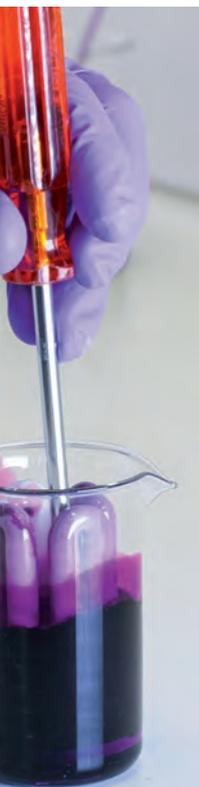
So ermittelt die Empa den Quecksilbergehalt in Energiesparlampen: Die Lampe wird in Kaliumpermanganatlösung getaucht und der Glaskörper aufgemesselt. Durch den Druckunterschied flutet die Lösung ins Lampenglas und holt das gasförmige Quecksilber heraus. Der Glaskörper wird dann gemahlen, die daran haftenden Anteile separat analysiert.
