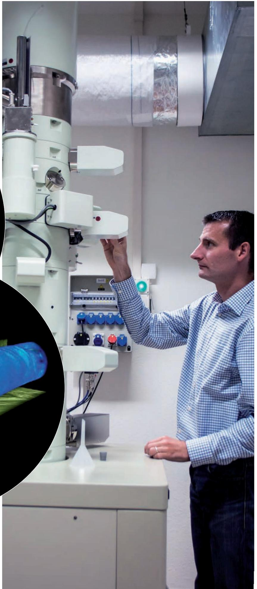
Rolf Erni bei der Arbeit am Elektronenmikroskop STEM. Die Einzelbilder werden elektronisch zusammengefügt. Oben: 3-D-Ansicht eines Lithiumeisenphosphat-Teilchens, wie es in Li-Ionen-Batterien vorkommt. Unten: Opalinuston, ein mögliches Barrierematerial für nukleare Abfälle.
