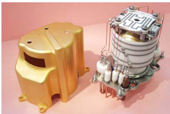
Ionenquelle des Flugzeitmassenspektrometers ROSINA-RTOF zur Messung von nicht-ionisierten Gasen
