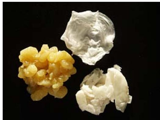
Extraits bruts d'un biopolymère (polyhydroxyalcanoate, PHA) avant (à gauche) et après purification (au centre et à droite).
