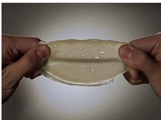
La réticulation des PHA non saturés permet d'obtenir des polymères biodégradables élastiques.
