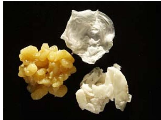
Massgeschneiderte Rohextrakte von Biopolymeren (Polyhydroxyalkanoat, PHA) vor (links) und nach der Reinigung (Mitte, rechts).
