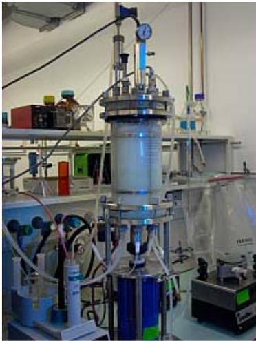
Kontrollierte Wachstumsbedingungen im Bioreaktor gewähren eine konstante, reproduzierbare Herstellung von Biopolymeren.
