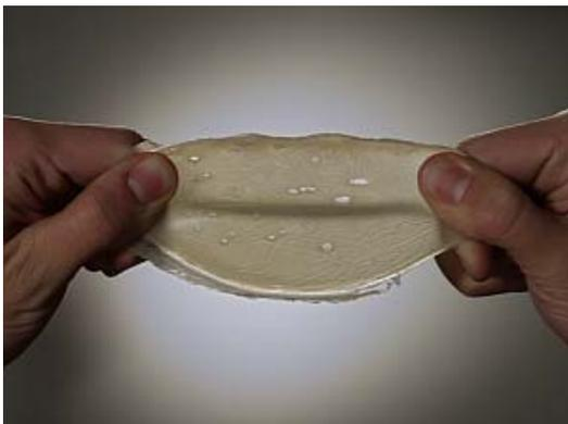
Quervernetzungen von ungesättigtem PHA ermöglichen die Herstellung eines bioabbaubaren Gummis.
