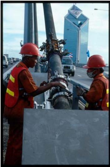
Mit einem an der Empa entwickelten Verfahren werden die Kabel der Rama IX Brücke in Bangkok geprüft.
