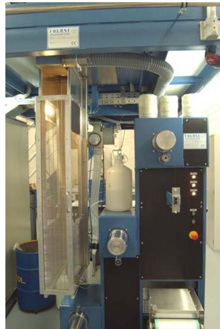
Détail de l'installation. A gauche gaine de soufflage et à droite étireuse-bobineuse
