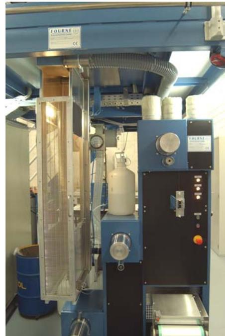
Detailansicht der Anlage. Links Blasschacht und rechts Streckspulmaschine
