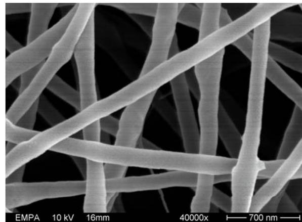
Les fibres polymères produites par électrofilage présentent une épaisseur de quelques nanomètres seulement. Elles peuvent servir à la production de filtres spéciaux ou de substrats pour les cultures de cellules humaines.
