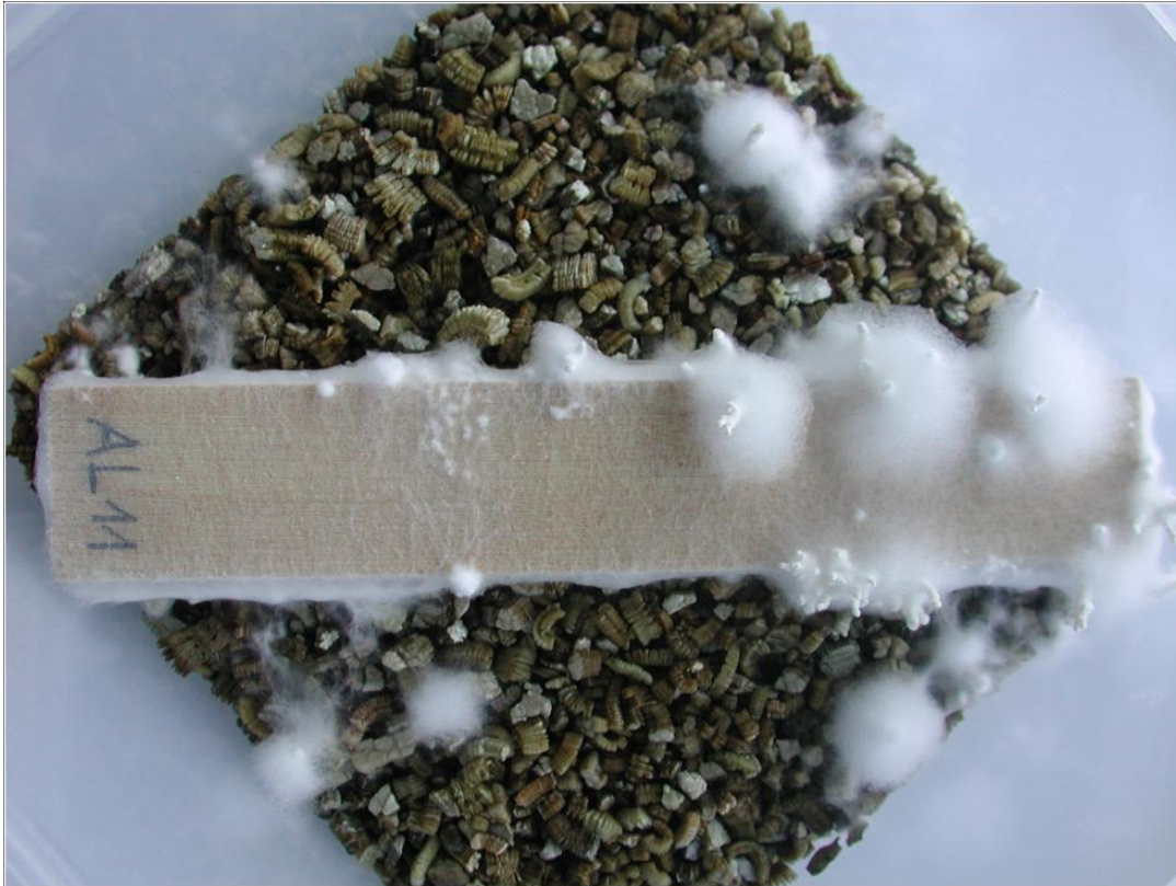
Mit Pilzen infizierte Fichtenholzprobe an der Empa
