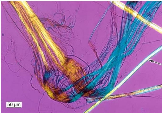
Faserbündel von Chrysotil im Polarisationslichtmikroskop
