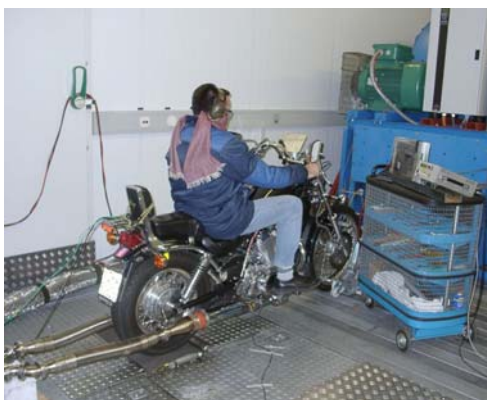
Simulation von Fahrverhalten im Motorenlabor der Empa in Dübendorf.
