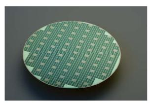
Une wafer usuel présente une épaisseur de 300 micromètres. Une technique optimisée devrait permettre de découper des disques de silicium de 100 micromètres d'épaisseur seulement.
