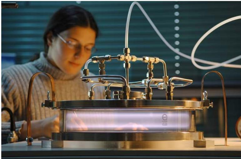
Pour lutter contre les germes hospitaliers, les textiles médicaux sont revêtus par déposition plasma d'une couche d'argent nanométrique qui réduit la contamination pas les microorganismes. Sur la photo l'installation plasma de laboratoire de l'Empa.
