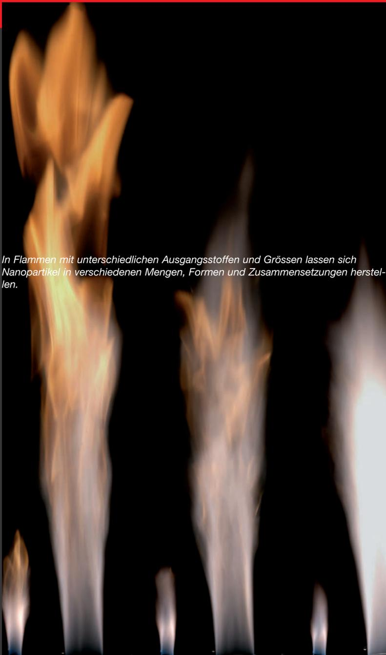
*In Flammen mit unterschiedlichen Ausgangsstoffen und Grössen lassen sich Nanopartikel in verschiedenen Mengen, Formen und Zusammensetzungen herstellen.*
