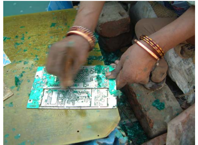
ArbeiterInnen entfernen unter einfachsten Bedingungen – oft mit hoch toxischer Substanzen – wertvolles Metall aus dem E-Schrott.
