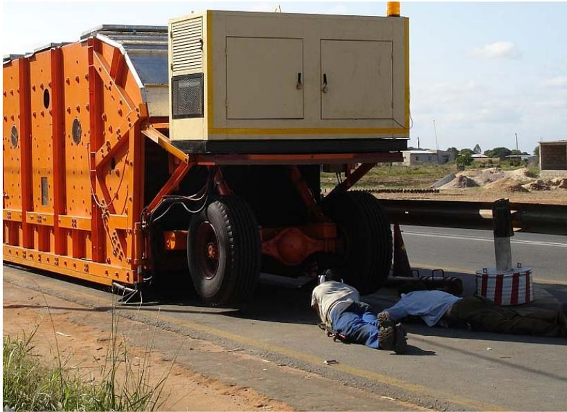
Les premiers tests en Afrique: le simulateur doit démontrer qu'il est effectivement capable de solliciter les revêtements routiers jusqu'à la destruction.
