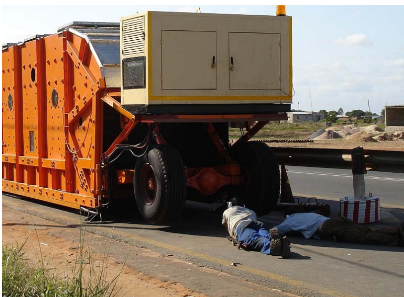
Erster Test in Afrika: Der Simulator soll demonstrieren, wie effektiv er Strassen zerstören kann.
