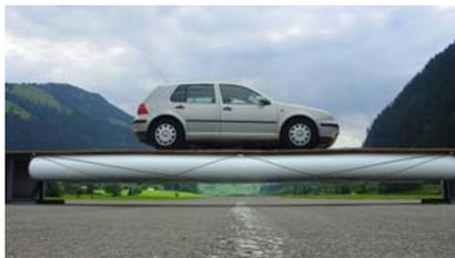
Pont de démonstration Tensairity d'une portée de 8 mètres et d'une capacité portante de 3.5 tonnes
