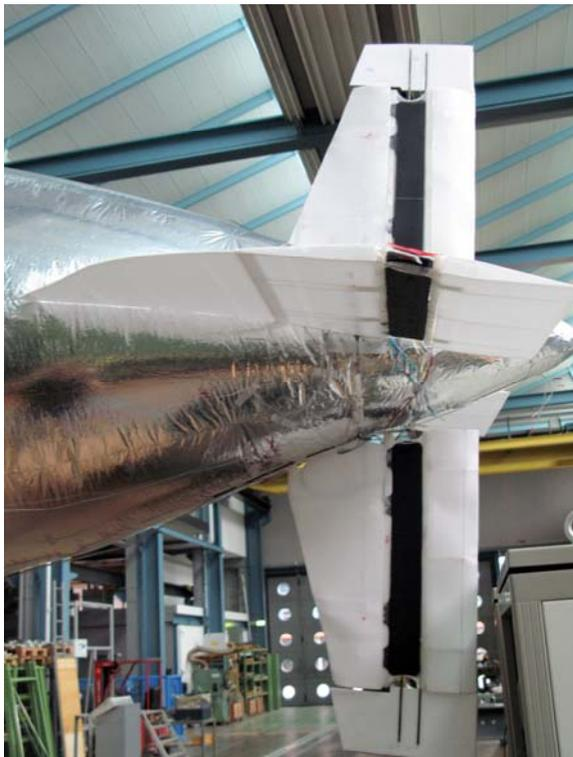
Sur le modèle actuel du dirigeable de l'Empa, des polymères électroactifs assurent l'actionnement des gouvernails de direction et de profondeur. Des feuilles de polymères élastiques activables électriquement assurent le rôle de charnières (en noir) sur l'empennage du dirigeable. (Photo: Empa)
