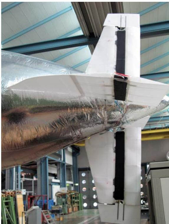
Beim aktuellen Modell des Empa-Prallluftschiffs übernehmen elektroaktive Polymere (EAP) die Höhen- und Seitensteuerung. Dazu sind die elektrisch aktivierbaren elastischen Polymerfolien als Scharniere im Leitwerk des Luftschiffs angebracht (schwarz). (Bild: Empa)
