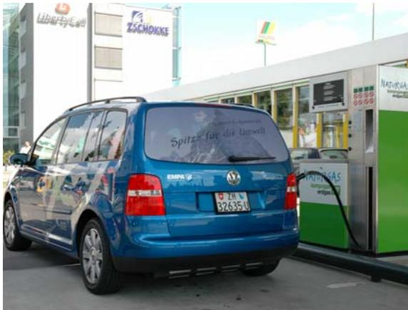
An einer der rund 60 in der Schweiz vorhandenen Erdgastankstellen wird das auf «echten» Erdgasantrieb ausgerüstete Empa-Versuchsfahrzeug (VW Touran EcoFuel) betankt.
