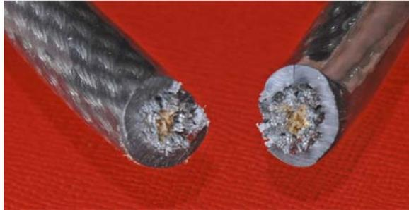
Le test de cisailage simulait l'attaque à l'aide d'un coupe-boulon solide (à gauche). Quelques cadenas à câble étaient déjà coupés sous une faible pression.
