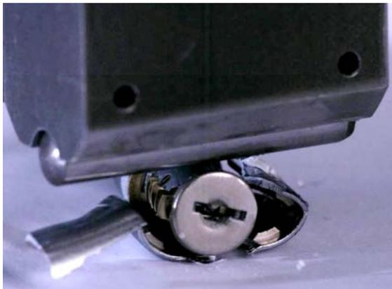
Un essai à la masse tombante filmé avec une caméra ultrarapide: le cylindre de fermeture de ce cadenas à câble s'est rompu déjà sous le premier coup de marteau.
