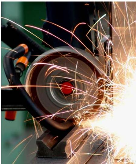
Même le cadenas en U le plus résistant était coupé en 50 secondes lors de l'attaque avec une tronçonneuse à disque. Les cadenas à câble les plus faibles résistaient moins de deux secondes à ce traitement.
