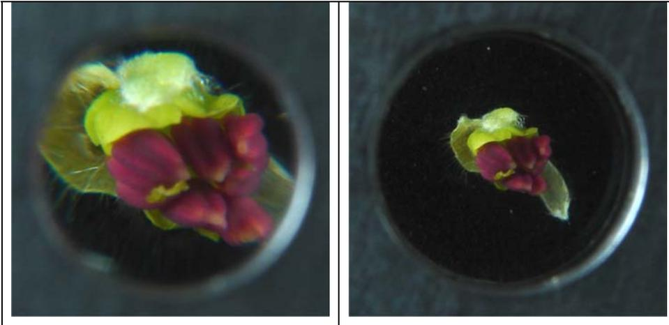
Durch Anlegen einer elektrischen Spannung kann die Brechkraft einer optischen Linse – und damit deren Vergrößerung – stufenlos variiert werden. Links ohne Spannung, rechts mit angelegter Spannung. (Bild: Optotune)
