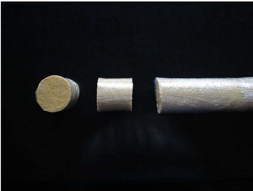
Un «powerpack» qui rend le béton plus ductile: les fibres nouvellement développées sont emballées de manière à pouvoir être ajoutées simplement au béton encore plastique. Cet emballage se dissout ensuite et les fibres se répartissent régulièrement dans le béton lors de son malaxage.
