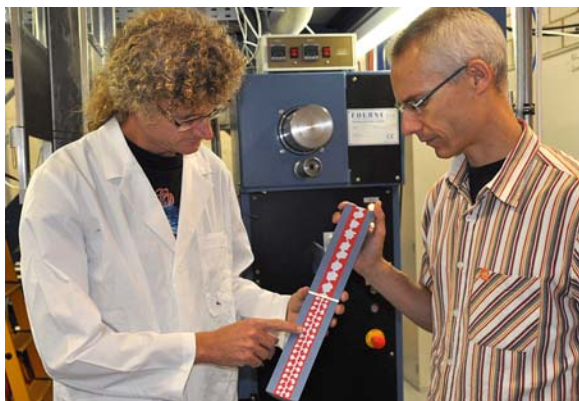
Neuheit der Empa: Am Innovation Day vorgestelltes Modell einer Mehrkomponentenfaser. Eine Spezialflüssigkeit im strukturierten Hohlkern der Faser bewirkt eine geschwindigkeitsabhängige mechanische Dämpfung. Diese Entwicklung soll flexible Schock-Absorber ermöglichen, beispielsweise bequem zu tragende Schutzwesten, die erst erstarren, wenn sie ein schneller Stoss trifft.
