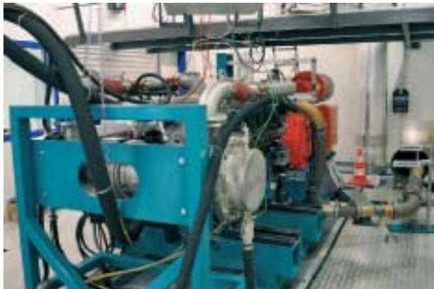
Le nouveau banc d'essai pour moteurs de poids lourds avec un couple pouvant atteindre jusqu'à 4000 newtons-mètres.
