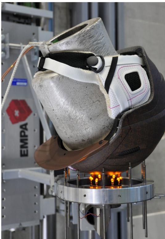
L'essai de chute simule un choc à une vitesse de 20 kilomètres à l'heure.
