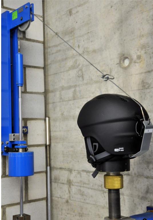
Lors du test d'arrachement, on vérifie si la jugulaire assure dans n'importe quelles circonstances le maintien en position exacte du casque.
