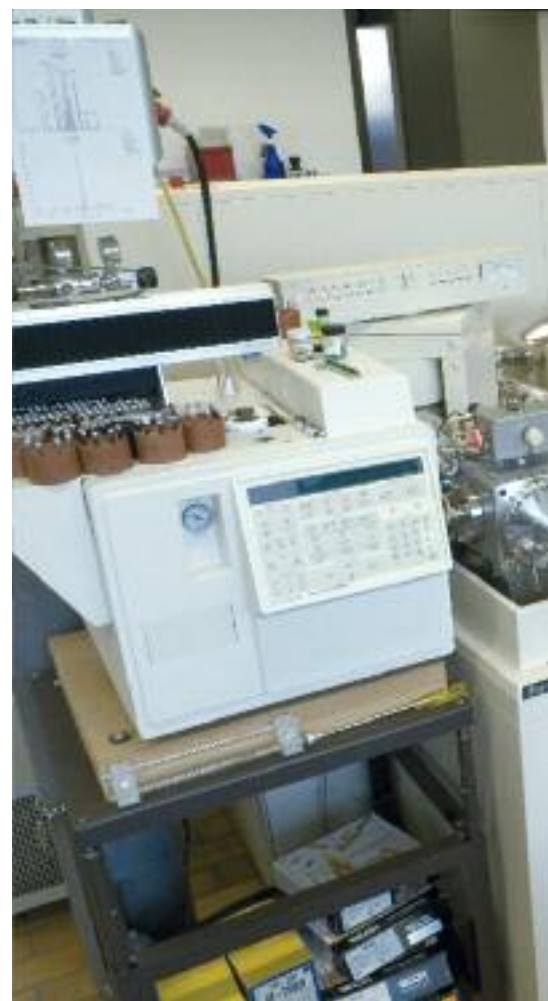
A l'Empa, les prélèvements ont été conditionnés puis analysés par chromatographie en phase gazeuse et spectrométrie de masse haute résolution. (Photo: Ruedi Keller)
