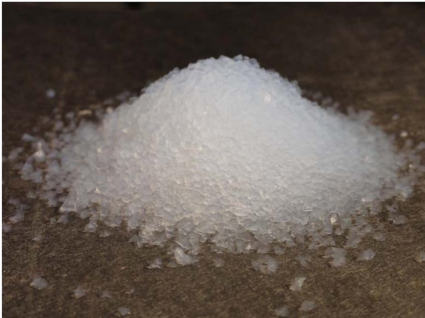
Die Hauptzutat des Putzes: Aerogel, ein Material aus mehr als 90 Prozent Luft.
