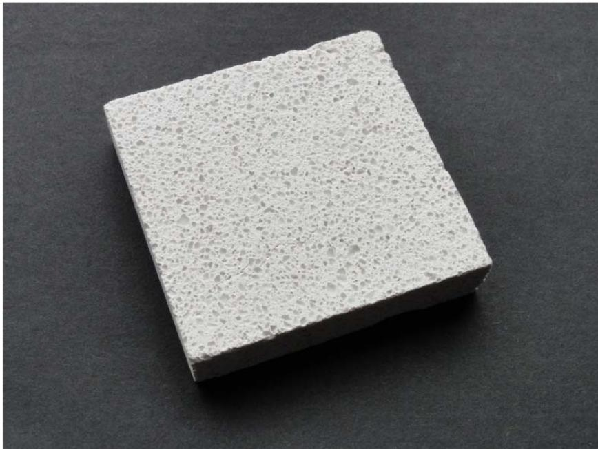
Der neue Dämmputz wird einfach mit der Verputzmaschine aufgespritzt; im Bild ein Block des Materials.
