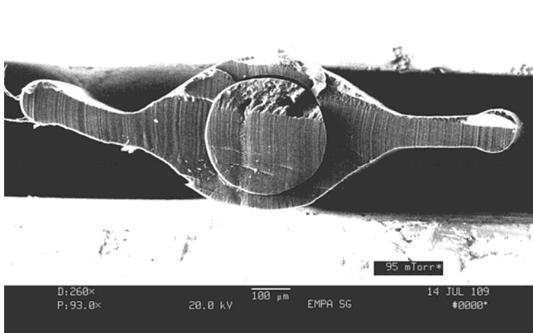
Bikomponentenfaser unter dem Rasterelektronenmikroskop: Während der Kern der Faser ihr etwa die nötige Steifigkeit verschafft, hat der Mantel aus unterschiedlichem Polymer eine anderweitige Funktion, beispielsweise eine optimierte Gleiteigenschaft.
