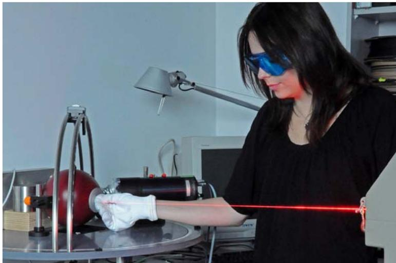
Messung des Lichtverlustes in einer polymeren optischen Faser.
