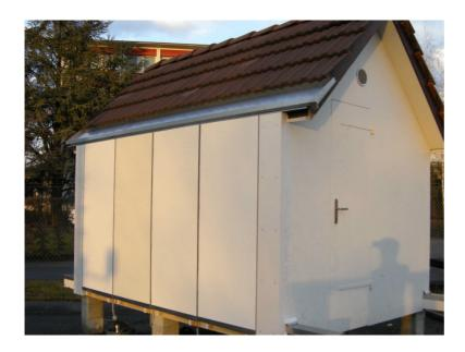
Construction expérimentale sur le site de l'Empa à Dübendorf: les éléments de façade comportent différents types de crépis et de peinture. Un des revêtements renferme des nanoparticules d'argent.
