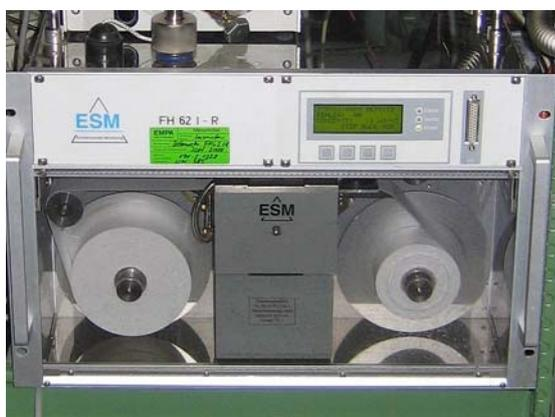
Appareil (Betameter) utilisé pour la mesure des poussières fines au Jungfraujoch, une des stations de mesure du réseau national d'observation de la pollution atmosphérique NABEL.
