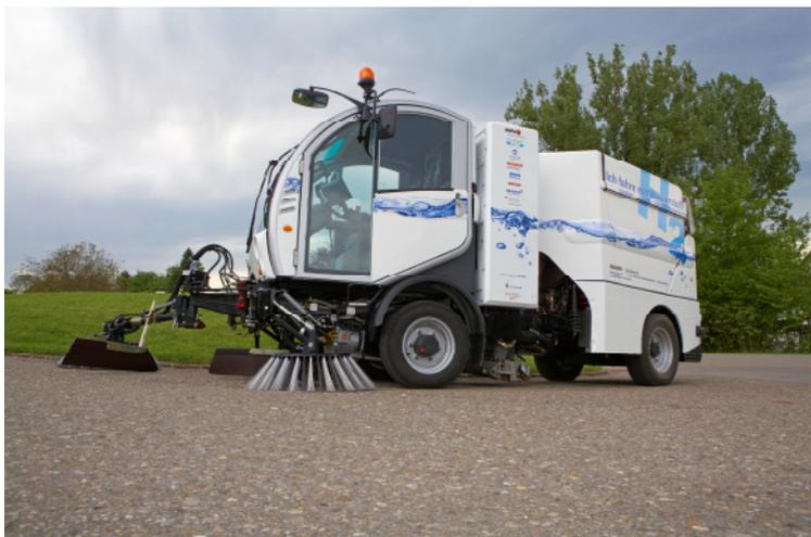
Einer der beliebtesten EmpaTV-Beiträge, der am häufigsten angeschaut wurde: ein Video über die emissionsfreie Strassenreinigungsmaschine «hy.muve», die mit Wasserstoff betrieben wird.
