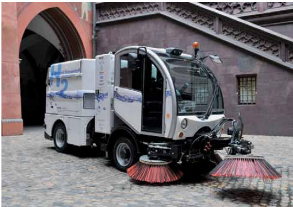
Die Kehrmaschine «Bucher Schörling CityCat H<sub>2</sub>» auf den Strassen von Basel: Das weltweit erste Kommunalfahrzeug mit Brennstoffzellenantrieb verbrauchte in der ersten Projektphase im Schnitt nur halb so viel Treibstoff wie ein konventionelles Fahrzeug. (Bild: Juri Weiss)
