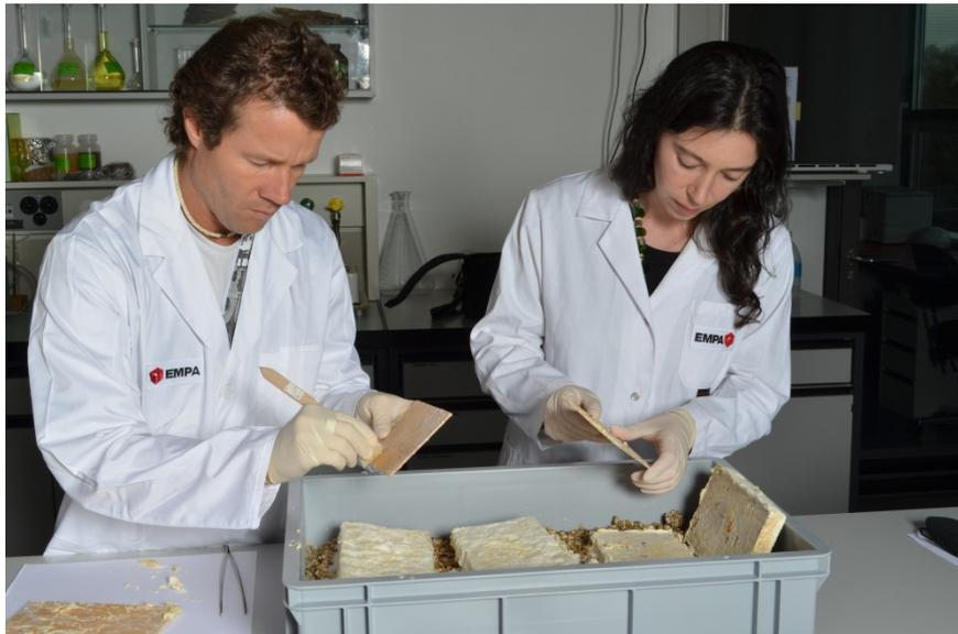
Im «Pilzlabor» wird das Klangholz systematisch Fäulnispilzen ausgesetzt. Markus Heeb und Iris Brémaud kontrollieren regelmässig, wie weit der Befall fortgeschritten ist.
