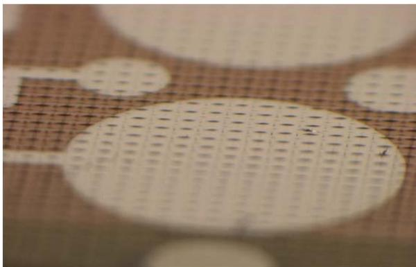
Im Labor hergestellte kreisrunde organische Solarzellen. Rotbraun: aktive organische Schicht; silbergrau: Top-Elektrode. Im Bild gut sichtbar sind die eingewobenen Metallfäden
