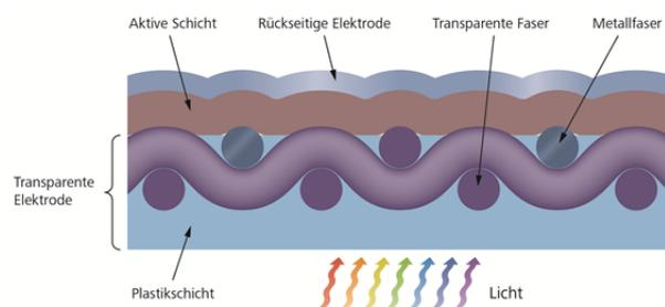
Querschnitt durch eine Dünnschicht-Solarzelle mit gewobener Elektrode
