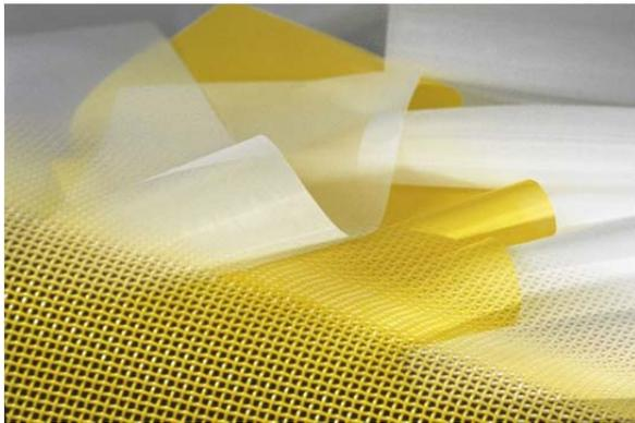
Flexibles Präzisionsgewebe, das in Zusammenarbeit mit der Schweizer Firma Sefar AG zu einer Elektrode für Dünnschicht-Solarzellen entwickelt wurde.
