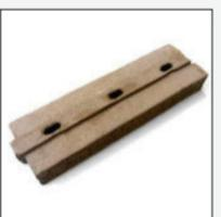
Dämmplatte aus Pilzen: Zu den neuartigsten Baumaterialinnovationen der Unit gehören sicherlich die Pilzstrukturen. Das Wurzelwerk von Pilzen (Mycelium) wird mit einer Nahrungsquelle vermischt – in diesem Fall mit Abfall-Holzspänen – und wächst in eine vorgegebene Form hinein. Nach einigen Tagen wird das Geflecht auf 60 bis 70 Grad Celcius erhitzt, wodurch der Organismus abstirbt. Das entstandene Material eignet sich beispielsweise als Dämmplatte in einer Wand.
