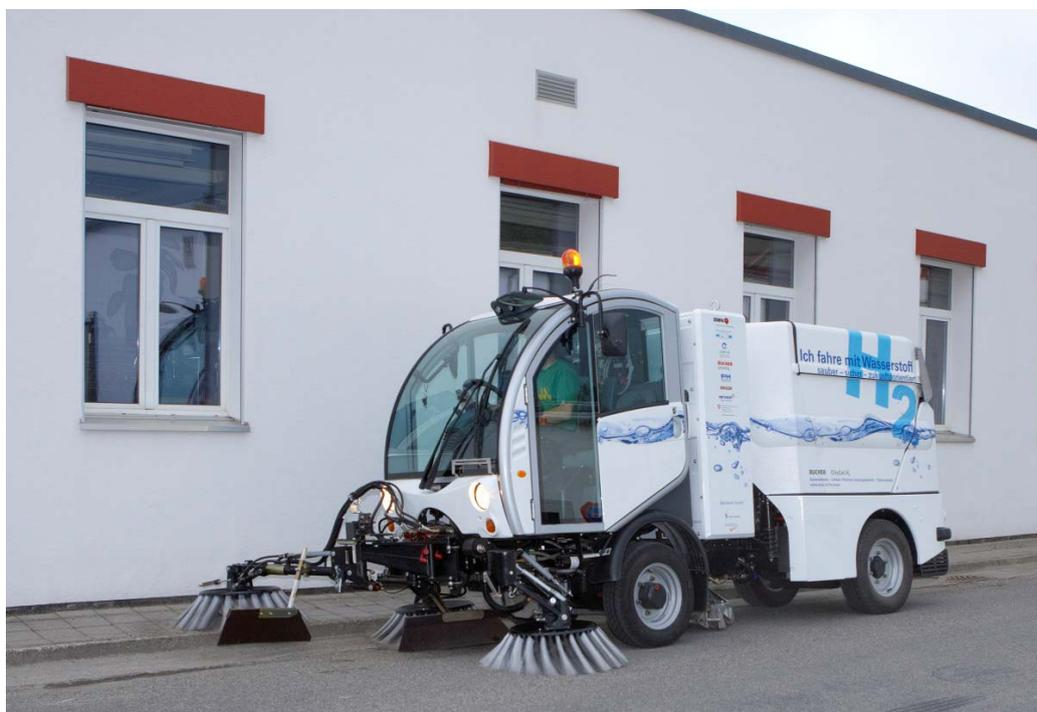
La balayeuse propulsée à l'hydrogène en action.
