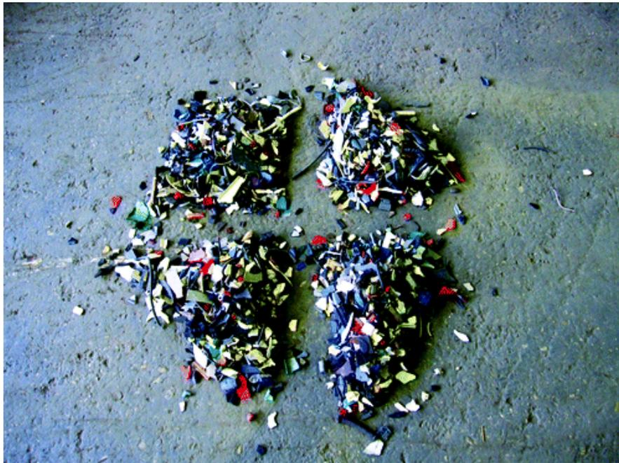
Kunststoffbestandteile werden von Recyclingunternehmen sortiert und zerkleinert, bevor sie der Wiederverwertung zugeführt werden.
