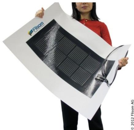
La cellule solaire polymère à couche mince (CIGS) développée par l'Empa et Flisom AG. (Photo Flisom)
