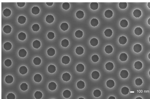
Membrane nanoporeuse, produite à partir d'une couche de silicium ultramince utilisable comme filtre. (Photo CSEM)
