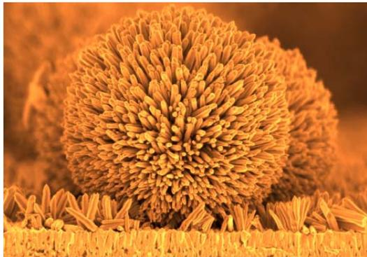
Les surfaces nanostructurées avec des nanofils agencés régulièrement possèdent d'excellentes propriétés de diffusion de la lumière. Elles se prêtent particulièrement bien aux applications en photovoltaïque car elles absorbent nettement mieux le rayonnement solaire et transforment finalement mieux l'énergie de rayonnement en électricité. (Photo Empa)
